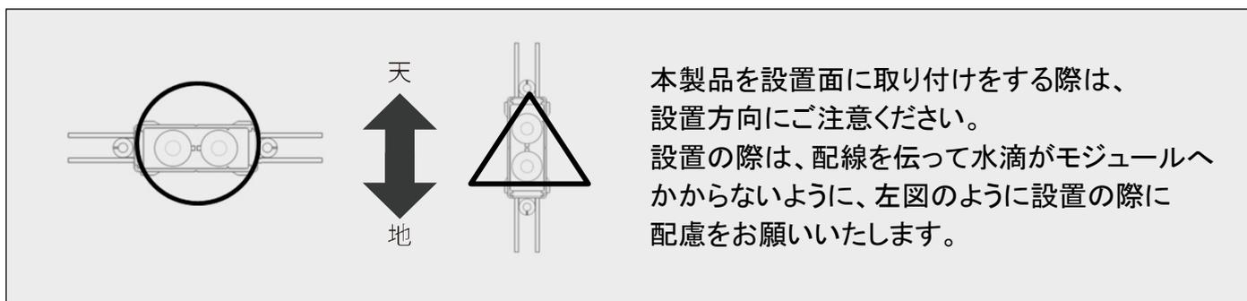
本製品を設置面に取り付けをする際は、設置方向にご注意ください。設置の際は、配線を伝って水滴がモジュールへかからないように、左図のように設置の際に配慮をお願いいたします。
