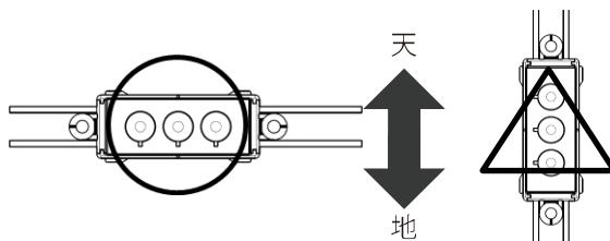
本製品を設置面に取り付ける際は、設置方向にご注意ください。設置の際は、配線を伝って水滴がモジュールへかかるないように、左図のように設置の際に配慮をお願いいたします。
