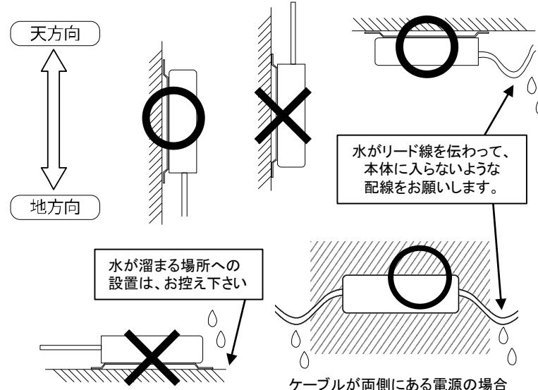
【注】下記品番の専用電源は、外郭ケースの勘合部が、製品ラベル面の裏側にあるため、製品ラベル面を下向きに設置しないで下さい。
