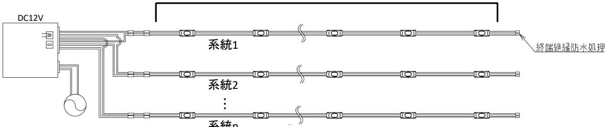
(※全系統の本製品合計数量は、使用する電源の「本製品使用可能範囲」内として下さい)
