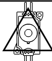
本製品を設置面に取り付けをする際は、設置方向にご注意ください。
