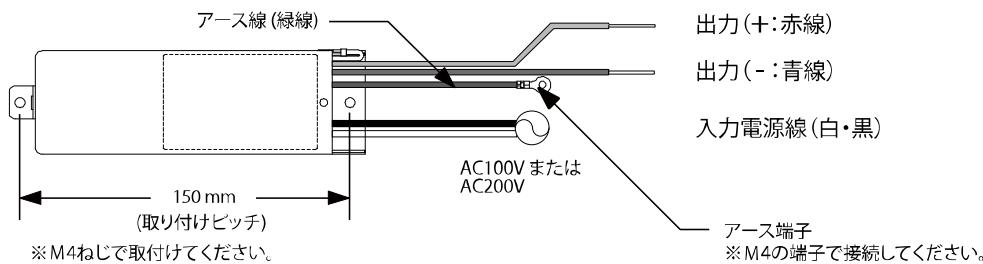
専用電源は屋外の器具組込用ですが、長くお使いいただくために下図に示すようにできるだけ、開口部に雨水などが溜まらないような、施工上の配慮をお願いします。
