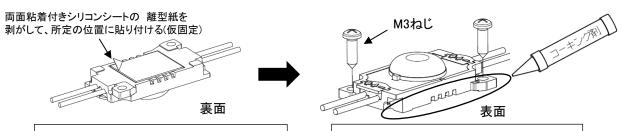
放熱の為、両面粘着付きシリコンシートは 必ず使用してください。 推奨締め付けトルク: 0.34N·m(3.4kgf·cm)
