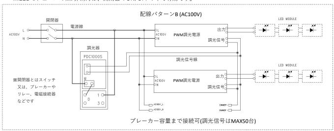
3. 調光器にAC100Vを接続、PWM調光電源にAC200Vを接続 ※LEDモジュールの点灯/消灯は、開閉器のON/OFFのみで有効です。
