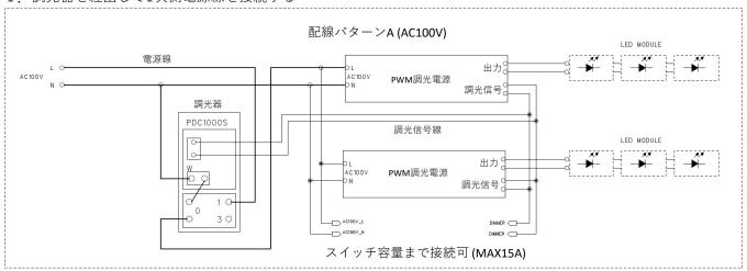
2. 調光器とPWM調光電源の一次側電源線を別々に接続する ※LEDモジュールの点灯/消灯は、開閉器のON/OFFのみで有効です。
